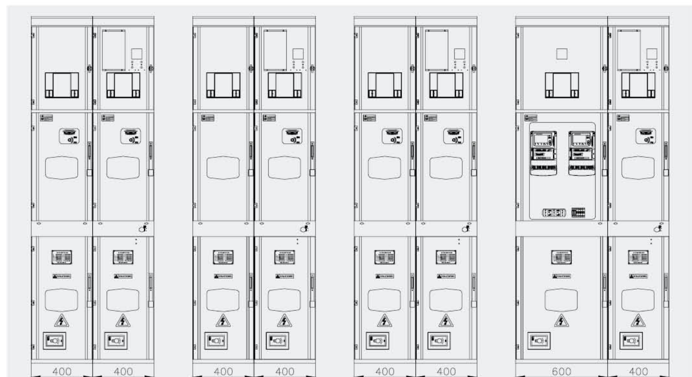
变压器出线柜采用真空断路器或真空负荷开关，均可按客户要求选择使用。
